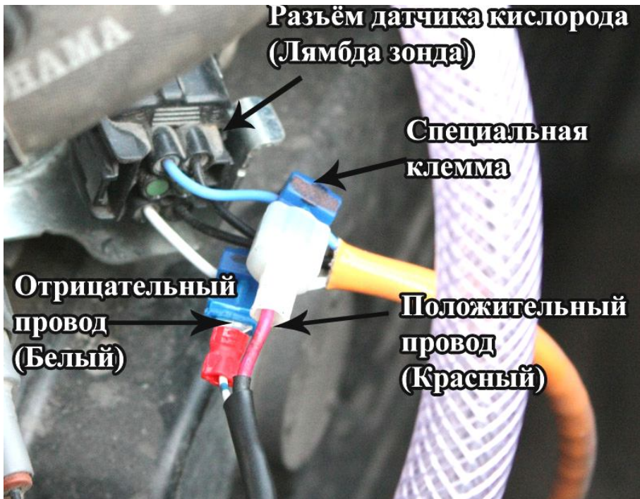
Рисунок 3.1. Схема подключения циркониевого датчика кислорода.
